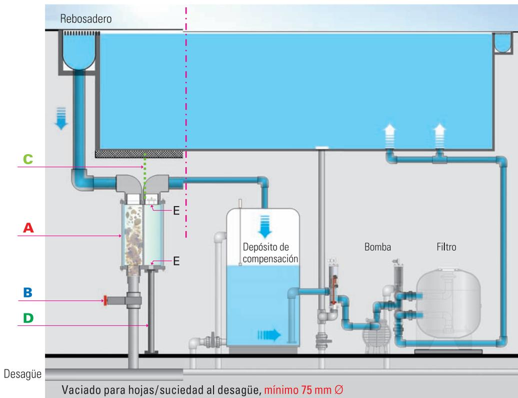
→ Tubería colectora del rebosadero, superior a 110 mm Ø → Montaje con By-pass.
