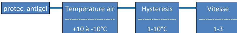
Pour utiliser la protection antigel, le capteur solaire est nécessaire. La température extérieure peut forcer la pompe de filtration à s'allumer. La température d'air minimale sélectionnée détermine le point de mise en marche de la pompe de filtration. L'hystérésis définit le point de coupure de la protection antigel. Le point de coupure est calculé comme suit: point de mise en marche + hystérésis. Pour les pompes à vitesse variable, la vitesse de la pompe peut être sélectionnée.
