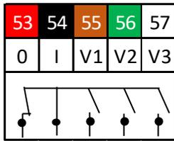
Commande pour pompes à vitesse variable: Pendant le fonctionnement, les contacts 53 et 54 sont ouverts. Lorsque le contact 53 + 54 se ferme, la pompe s'arrête.
