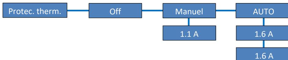
Les pompes de filtration à vitesse variable ne sont pas connectées à l'ASC4, mais directement à partir d'une prise de courant. La protection moteur est ainsi réglée sur «Off».
